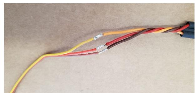
Die kleinen Schrumpfschläuche über die Lötstellen ziehen und erhitzen, z.B. mit einem Feuerzeug.
